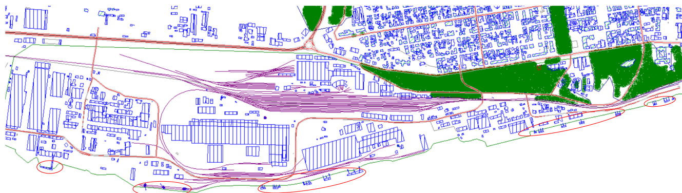
Fig.nr. 4: Sursele de zgomot de natură industrială în port – evidențiate cu elipse roșii
